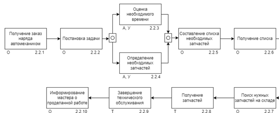
Рис. 1. Организационно-логические и временные связи подпроцесса «Техническое обслуживание транспортного средства»
