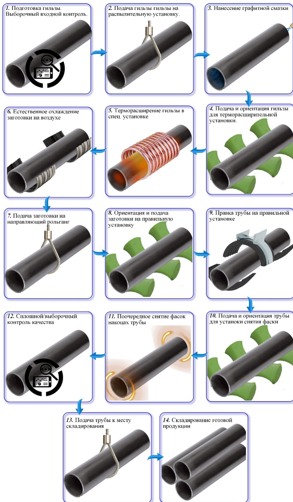
Рисунок 4 – Технологический процесс производства трубной продукции методом горячего экспандирования (с применением СВЧ нагрева) Источник: разработано автором
